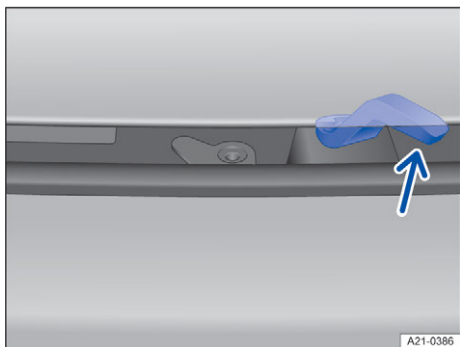
Sl. 179 Iznad rešetke hladnjaka: ručica za otvaranje prednjeg poklopca.
