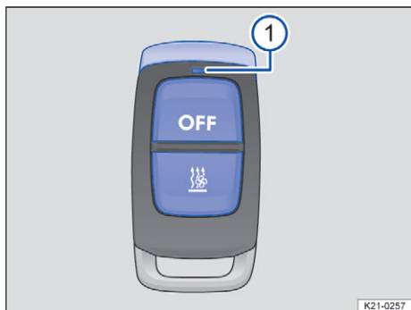
Sl. 88 Daljinski upravljač na radiosignal za grijanje vozila u mirovanju.
