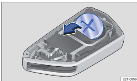
Sl. 48 Ključ vozila: zamjena dugmaste baterije.
