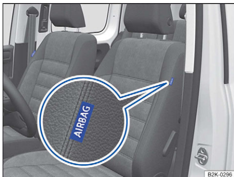
Sl. 30 Bočno u prednjem sjedalu: mjesto ugradnje bočnog zračnog jastuka.
