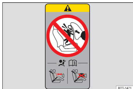
Sl. 34 Prikaz principa: naljepnica za zračni jastuk na B stupu.
