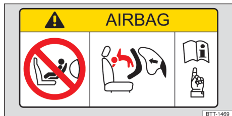
Sl. 33 Prikaz principa: naljepnica za zračni jastuk na zaslonu za sunce.
