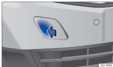
Sl. 176 U braniku sprijeda desno: skidanje poklopca.
